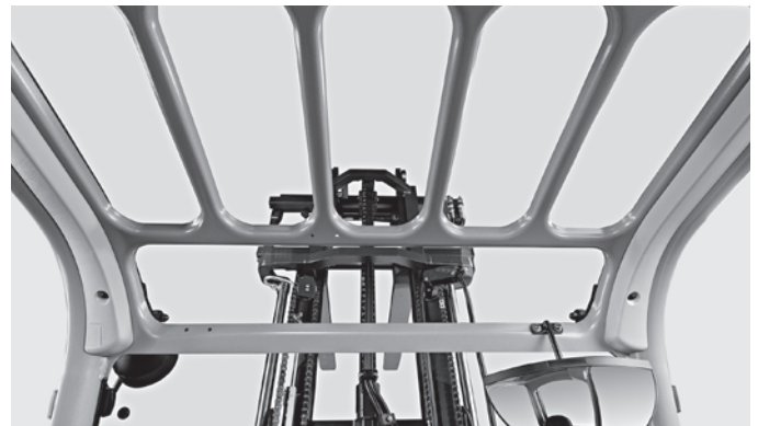
Optimale Durchsicht dank schmaler Schutzdachprofile
