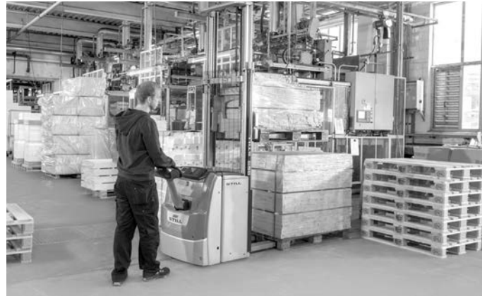
Hohe Umschlagleistung dank Transport zweier nicht stapelfähiger Ladungsträger
