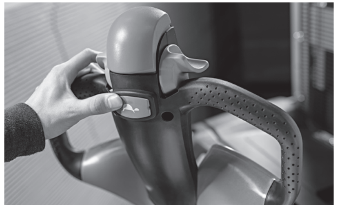
Präzise in jeder Situation: Mit dem optionalem Schleichfahrtstaster ist es möglich, in engsten Räumen zu manövrieren
