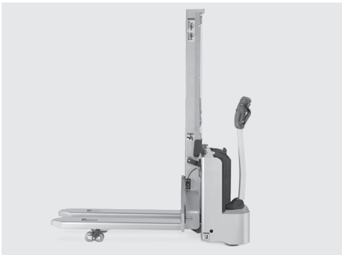
Bodenschwellen überwinden leicht gemacht mit optionalem Initialhub für mehr Bodenfreiheit
