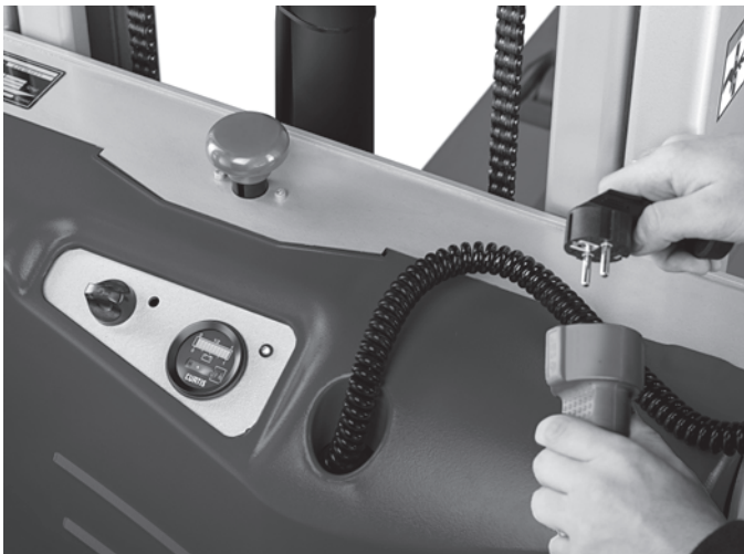
Einbauladegerät gewährleistet höchste Verfügbarkeit und ermöglicht dezentrales Laden
